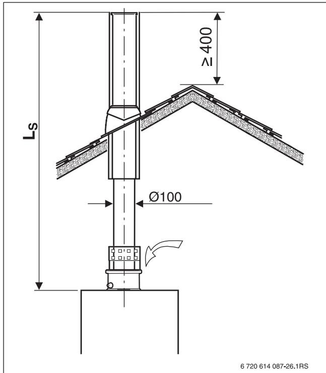
Рис 12 Одинарная труба через крышу (B<sub>23</sub>)
