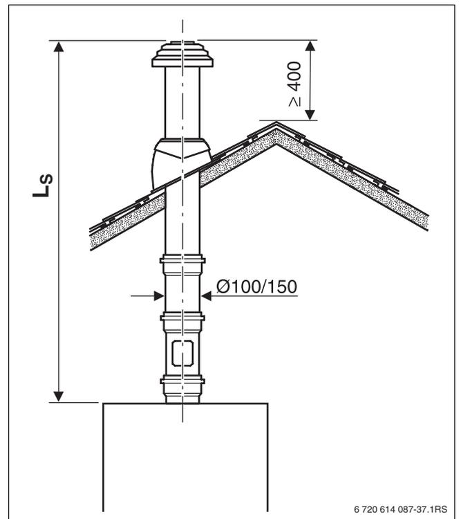
Рис 18 Вертикальная двойная труба (C<sub>33(x)</sub>)
