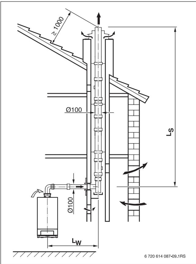
Рис 14 Одинарная труба в шахте ( $V_{23}$ , жёсткая)
