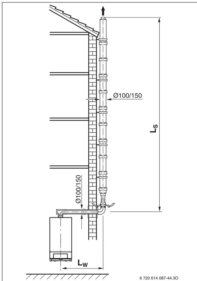
Рис 22 Двойная труба на фасаде ( $C_{53(x)}$ )
