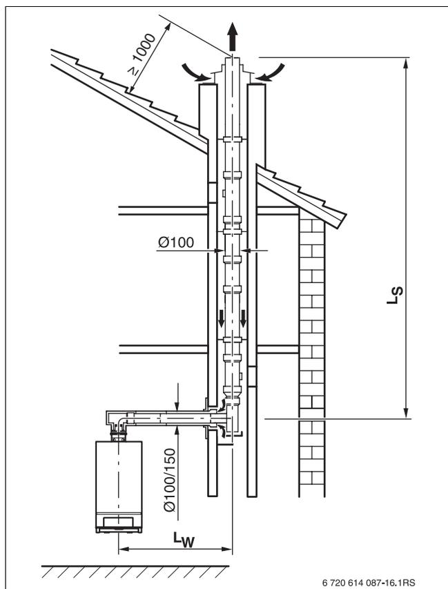
Рис 19 Дымовая труба в шахте, жёсткая ( $C_{33}$ )
