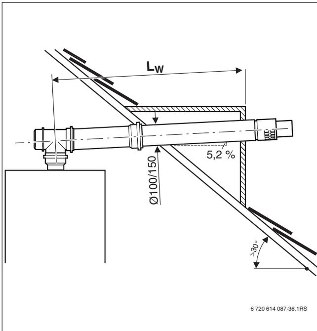
Рис 17 Горизонтальная двойная труба (C<sub>33(x)</sub>)
