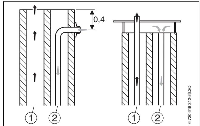
Рис 1 Примеры расположения устьев труб (размеры в м)
