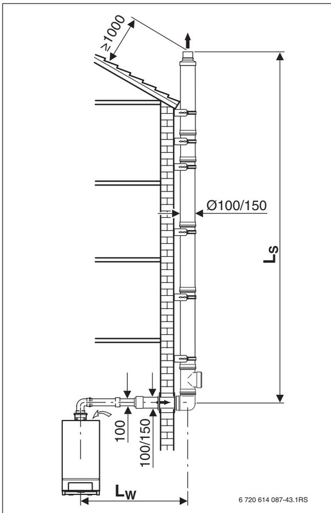
Рис 16 Двойная/одинарная труба на фасаде ( $B_{23}$ )
