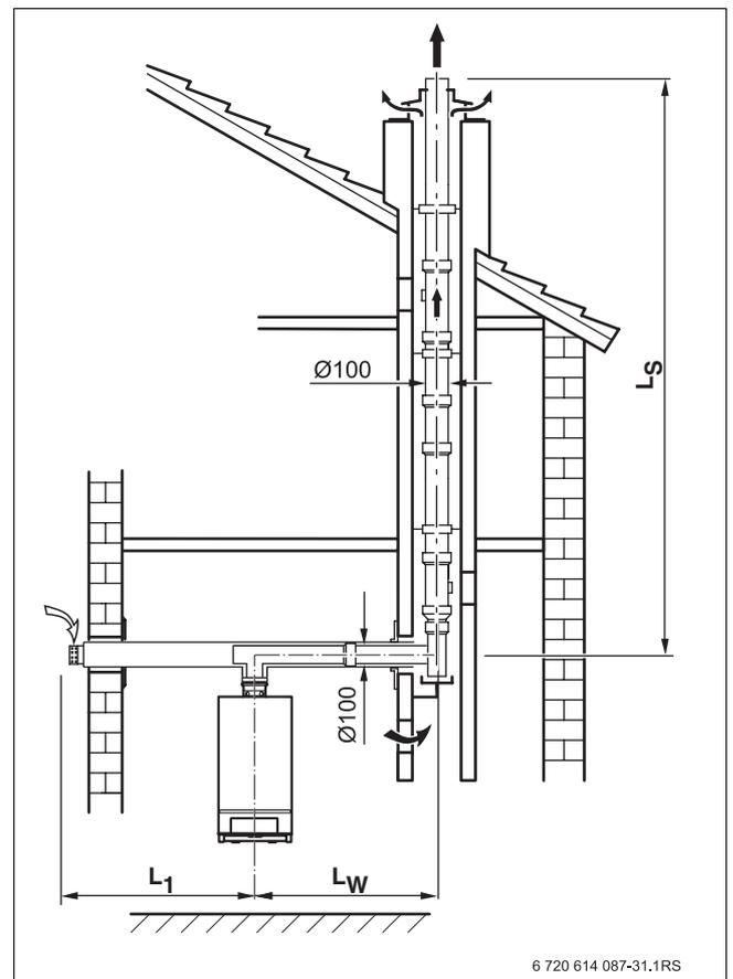
Рис 23 Раздельные трубы в шахте ( $C_{83(x)}$ )
