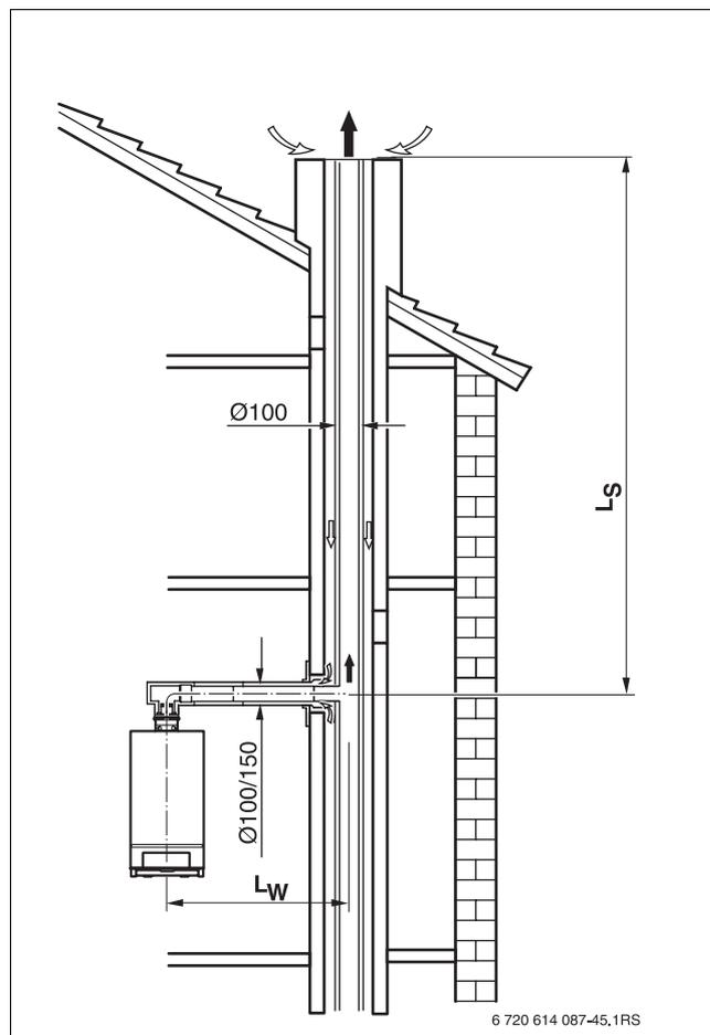
Рис 21 Двойная труба до существующей шахты (C<sub>43(x)</sub>)
