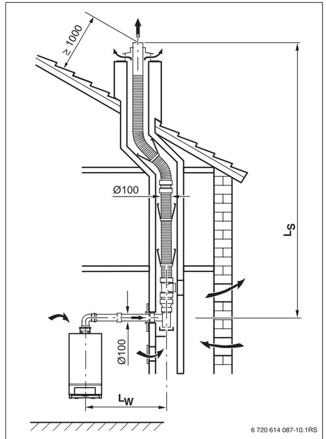
Рис 15 Одинарная труба в шахте ( $V_{23}$ , гибкая)
