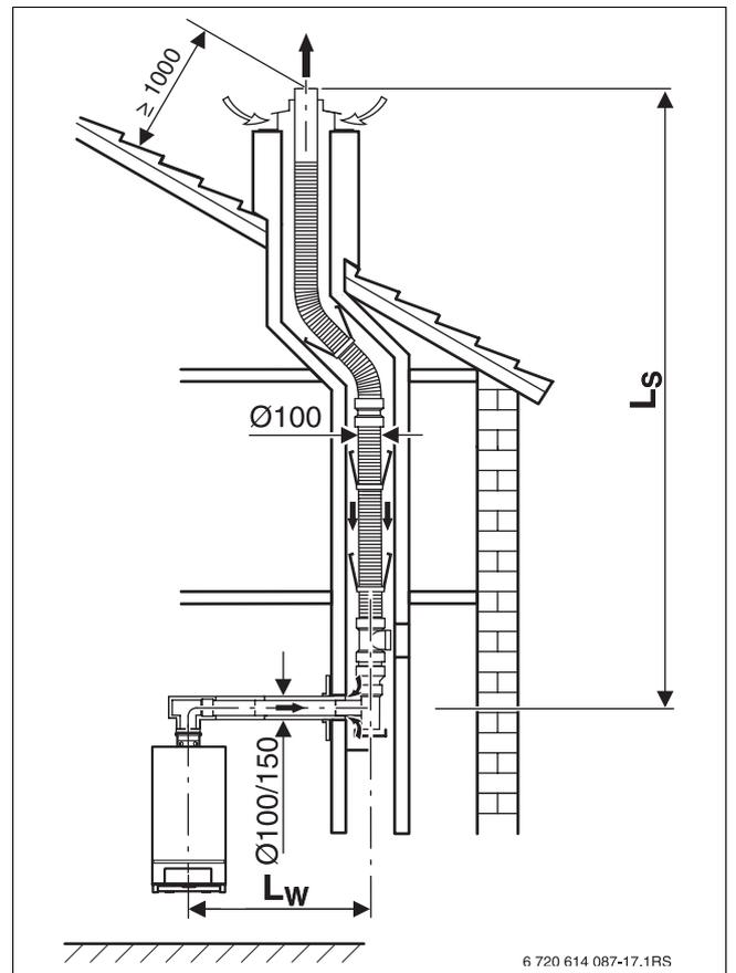
Рис 20 Дымовая труба в шахте, гибкая (C<sub>33</sub>)
