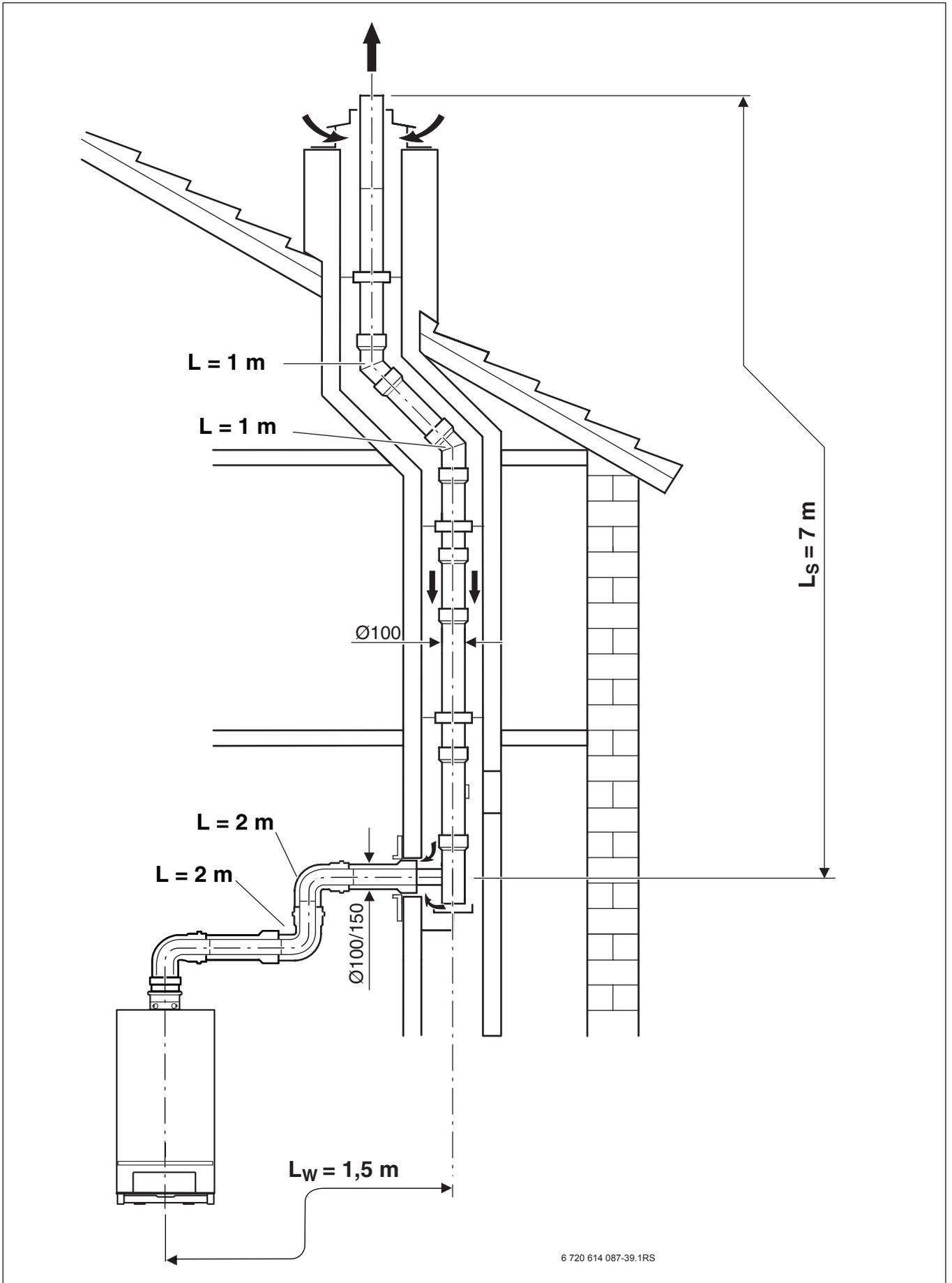
Рис 11 Пример определения длины дымовых труб
