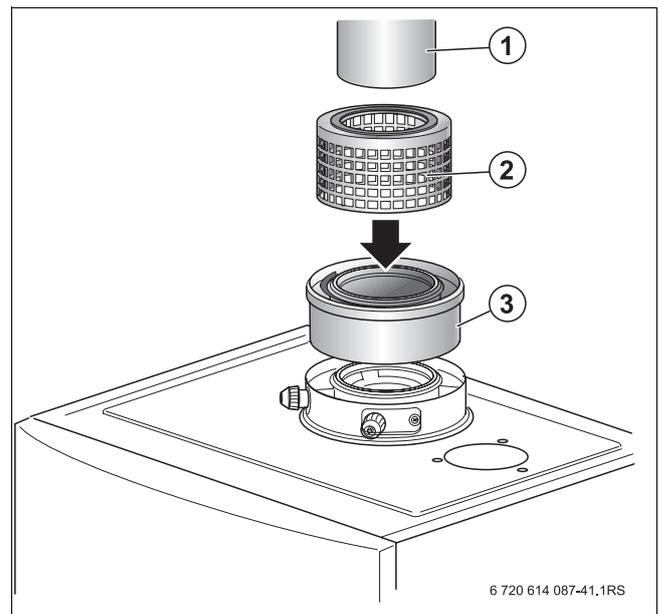
Рис 3 Забор воздуха для горения из помещения и одинарная труба отвода дымовых газов
