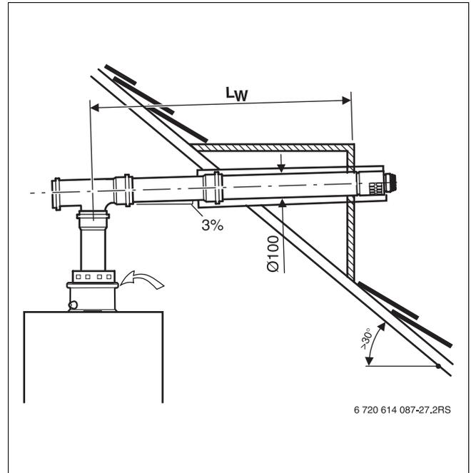
Рис 13 Одинарная труба через крышу (B<sub>23</sub>)
