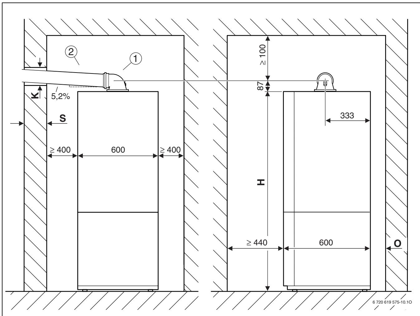
Рис 6 Ø 60/100 мм
