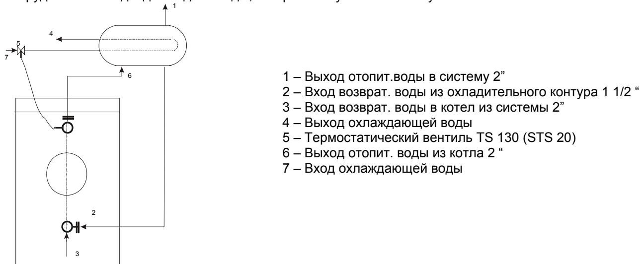
Рис. 4 Гидравлическая схема присоединения охлаждающего контура
