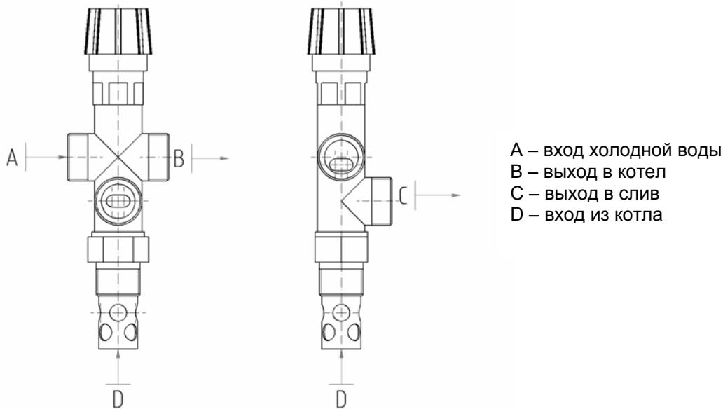
Рис. 5 Двухходовой защитный клапан DBV 1 - 02
