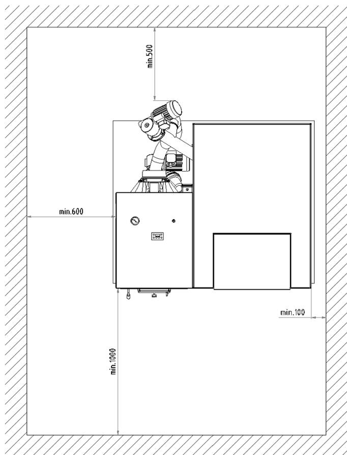
**Рис. 6 Расположение котла VIADRUS HERCULES ECO в котельной**
