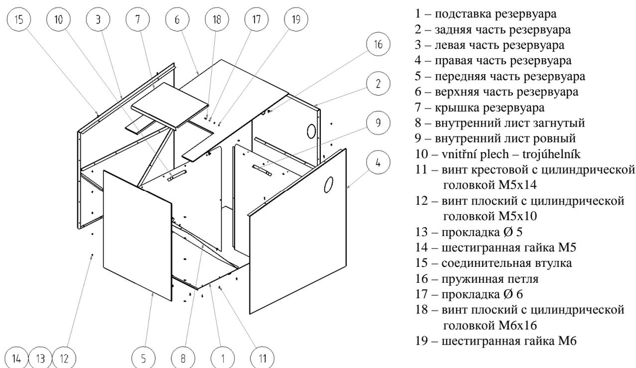
**Рис. 10 Монтаж топливного резервуара**
