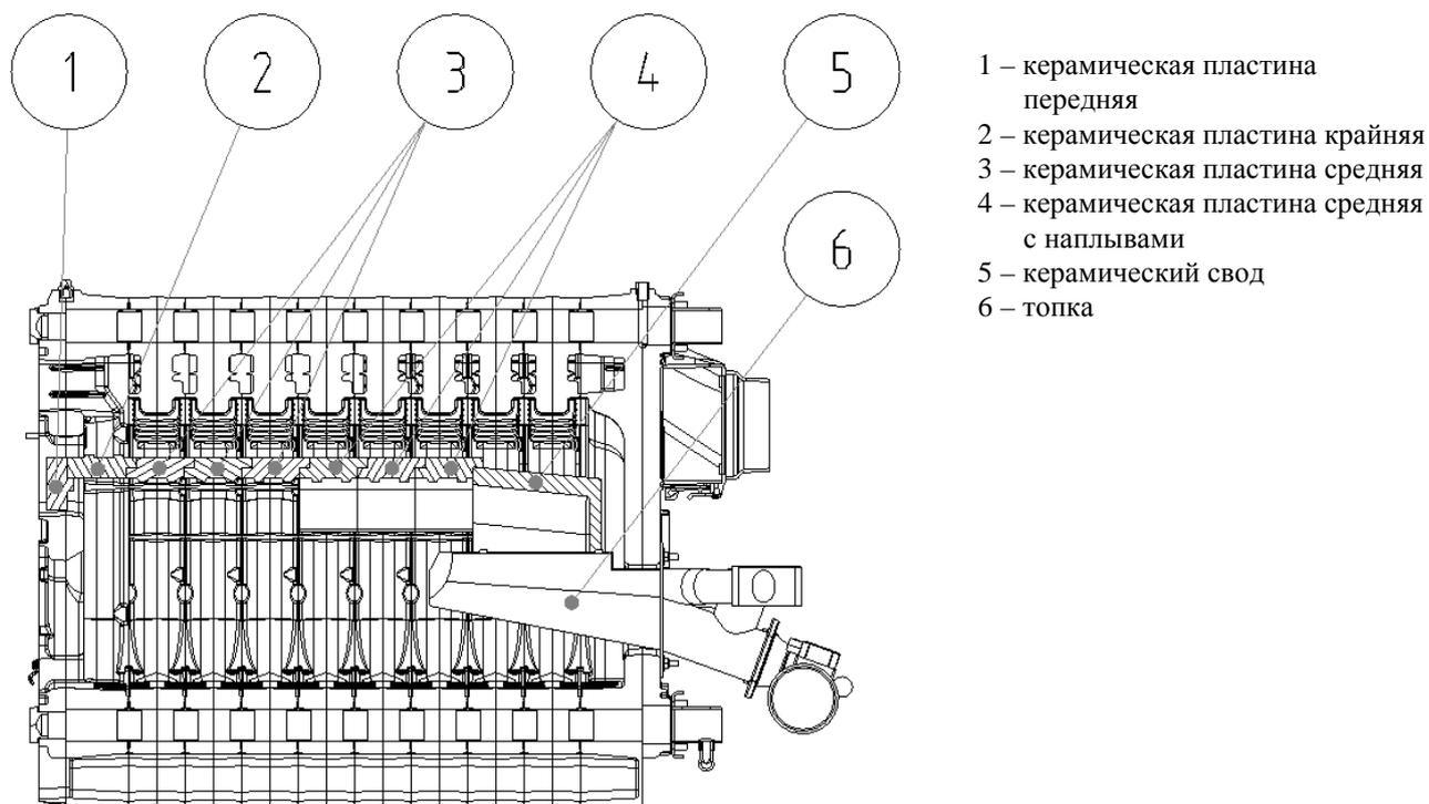
**Рис. 16 Укладка керамических пластин в 10-секционный теплообменник**
