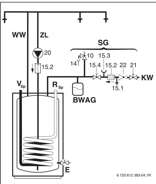
Рис 4 Схема подключения со стороны санитарной воды
