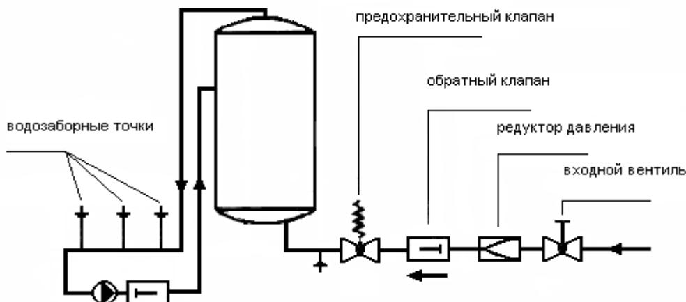
Схема обвязки водонагревателя с линией циркуляции
