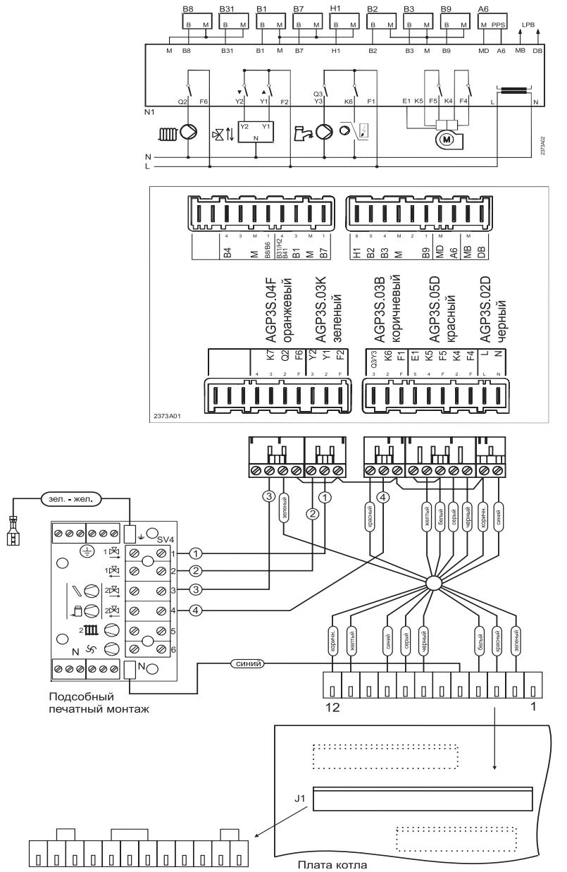
**Схема подключения присоединительного комплекта для котла KLO и регулятор RVA 63.280**
