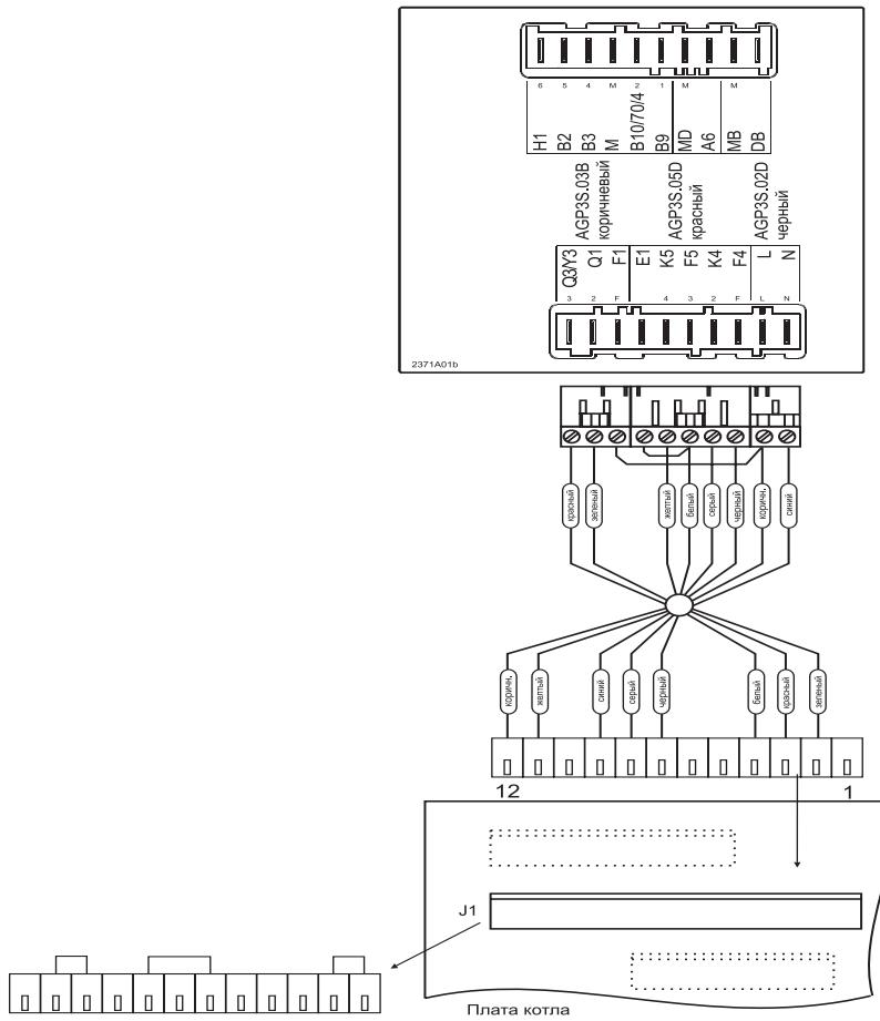
**Схема подключения присоединительного комплекта для котла KLO и регулятор RVA 63.242**
