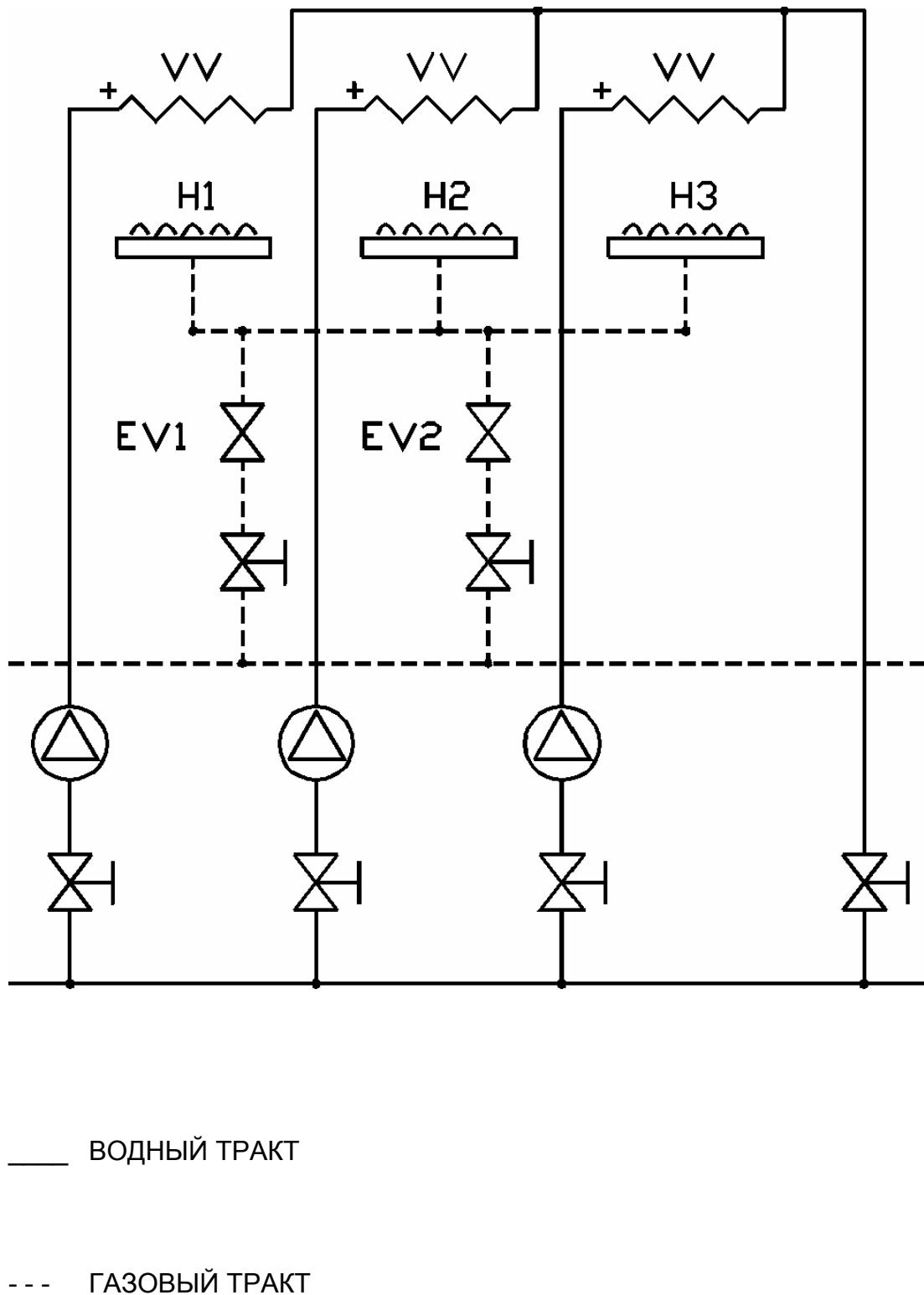
**Рис.1 - Схема протока воды и газа через модуль**
