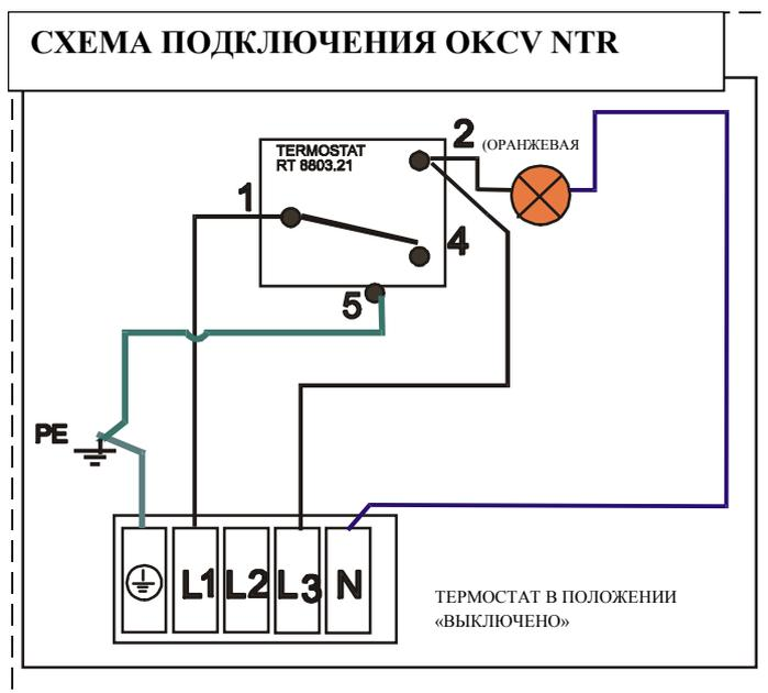
Обогреватель можно подключить к любому котлу центрального отопления с мощностью до 50 кВт, дистанционно управляемому с помощью термостата на напряжение 230 В/50 Гц. Электрическое питание 230 В/50 Гц подаётся на обогреватель прямо от котла. Для подключения может быть использован кабель CYSY 4С x 0.75. Клеммы питания обозначены на клеммнике обогревателя.
