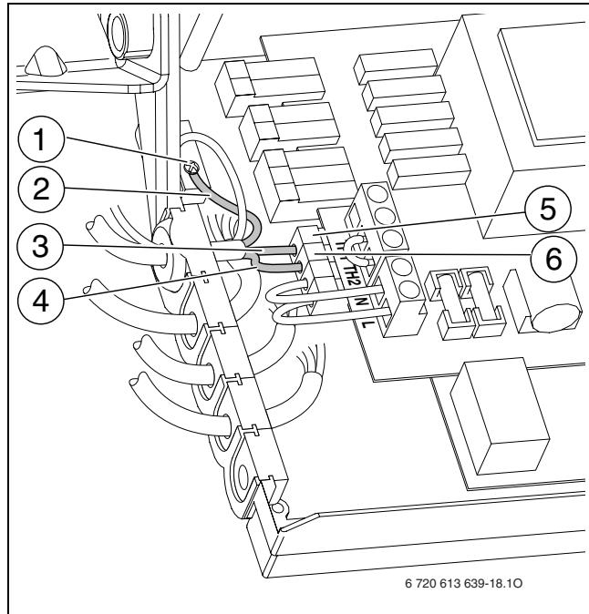
Рис 19 Подключение сетевого кабеля 230 В переменного тока
