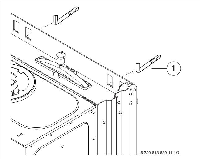
Рис 12 Подвешивание прибора
