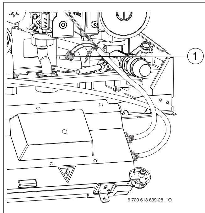
Рис 20 Разъем для подключения датчика температуры бойлера (NTC)
