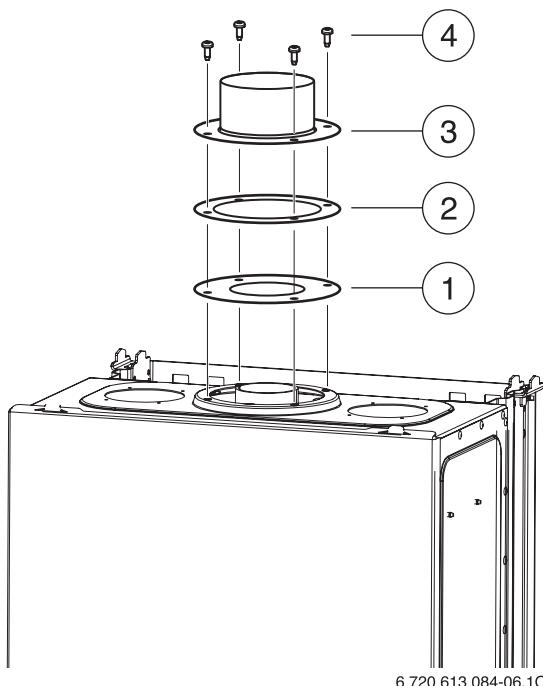
Рис 14 Монтаж системы отвода продуктов сгорания
