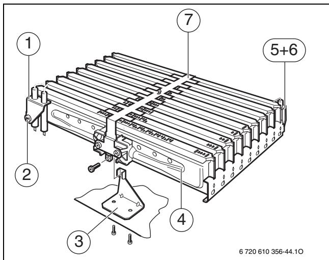
Рис 40 Узел горелки
