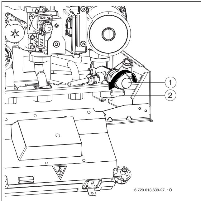
Рис 46 Предохранительный клапан
