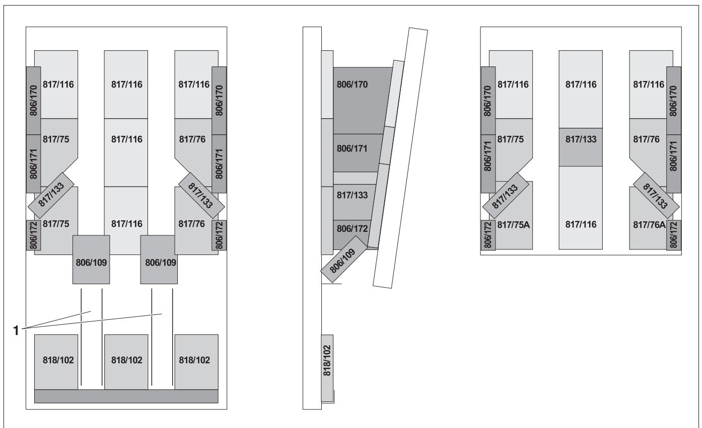
Рис. 18 Укладка шамотных кирпичей для типа DOR 32 D
