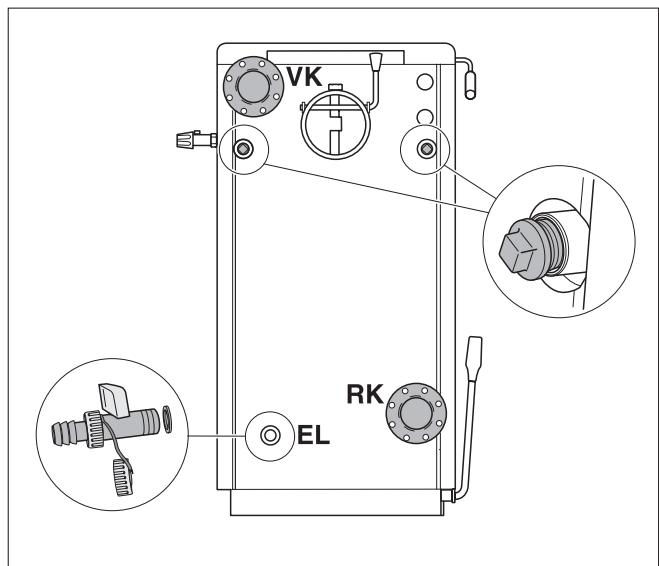
Рис. 11 Гидравлические подключения
