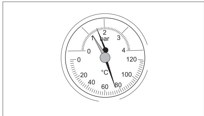
Рис. 14 Термоманометр
