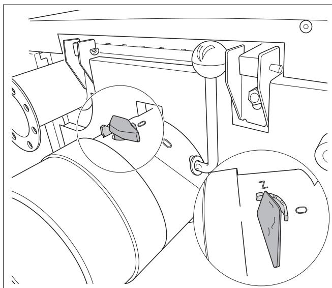
Рис. 19 Регулировка дымовой заслонки
