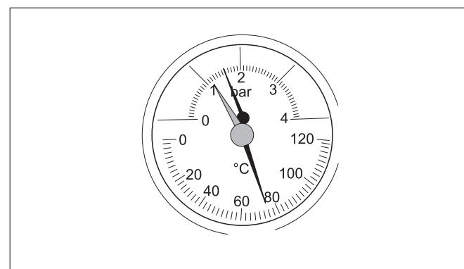
Рис. 38 Термоманометр
