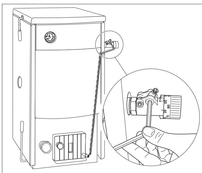
Рис. 20 Регулировка натяжения цепи
