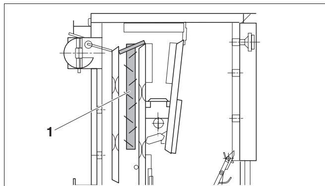
Рис. 36 Турбулятор в тракте дымовых газов
