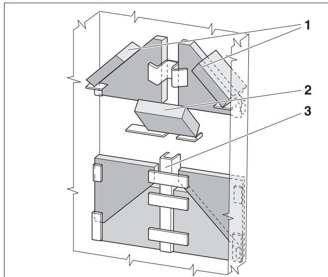
Рис. 15 Укладка шамотных кирпичей для типов DOR 12, DOR 16
