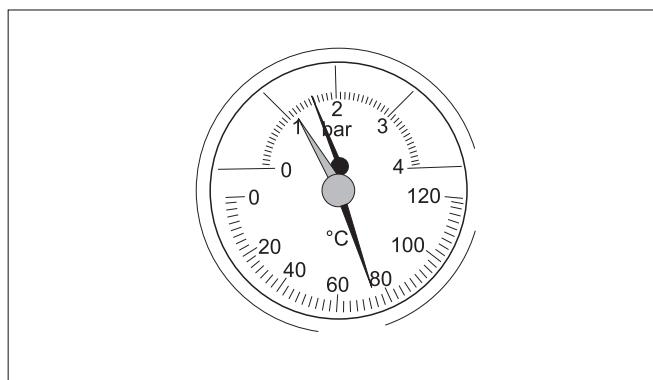
Рис. 13 Термоманометр
