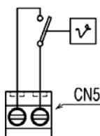
Термостат температуры в помещении (24В) подключается, как показано на схеме. Сначала необходимо снять перемычку на клеммной колодке с 2 контактами (CN5).
