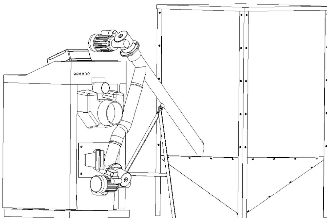
**Рис. но. 2 Вид котла сзади VIADRUS HERCULES ECO с бункером топлива – левая версия**
