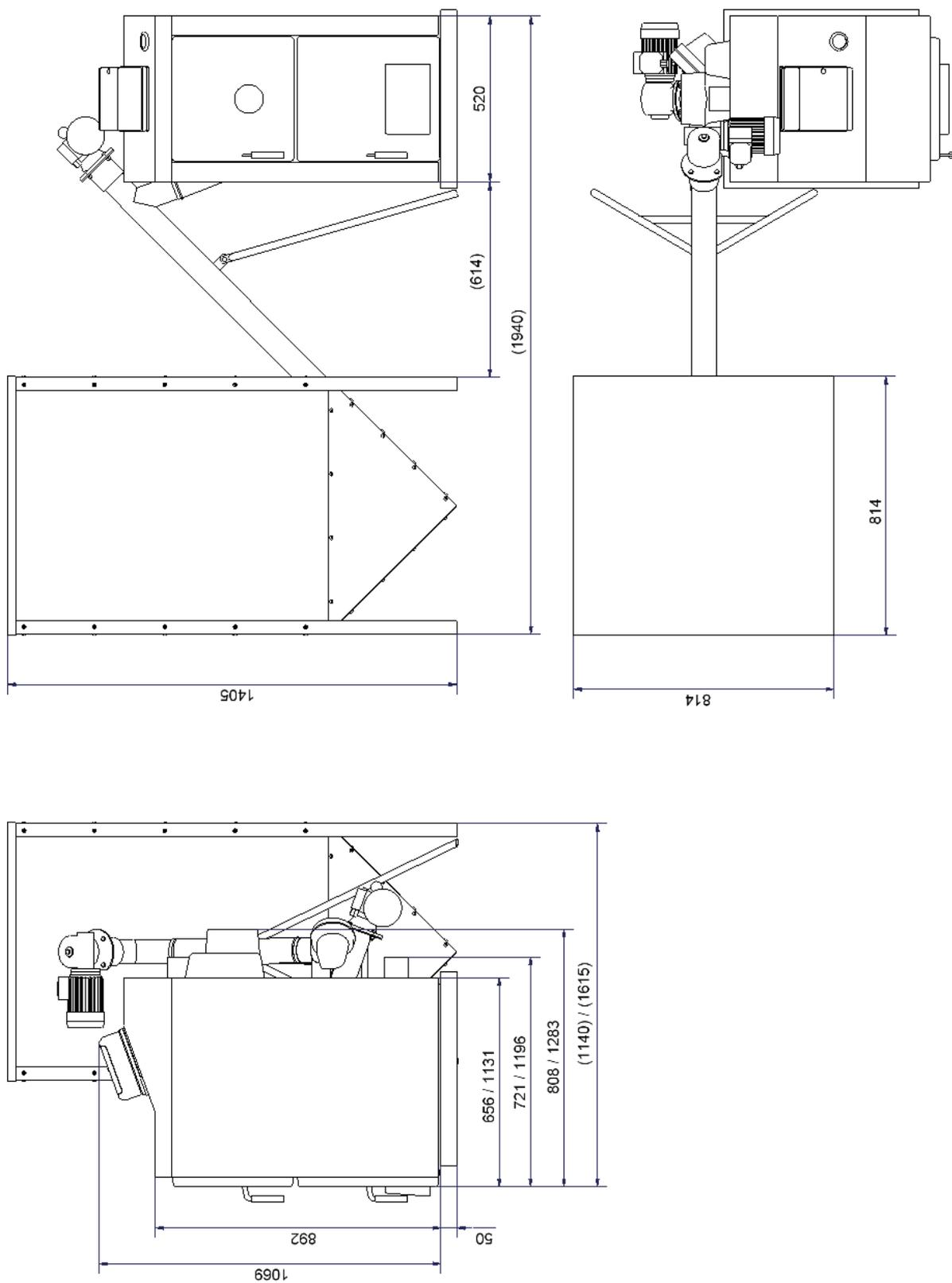
**Рис. no. 3 Размеры котла VIADRUS HERCULES ECO**
