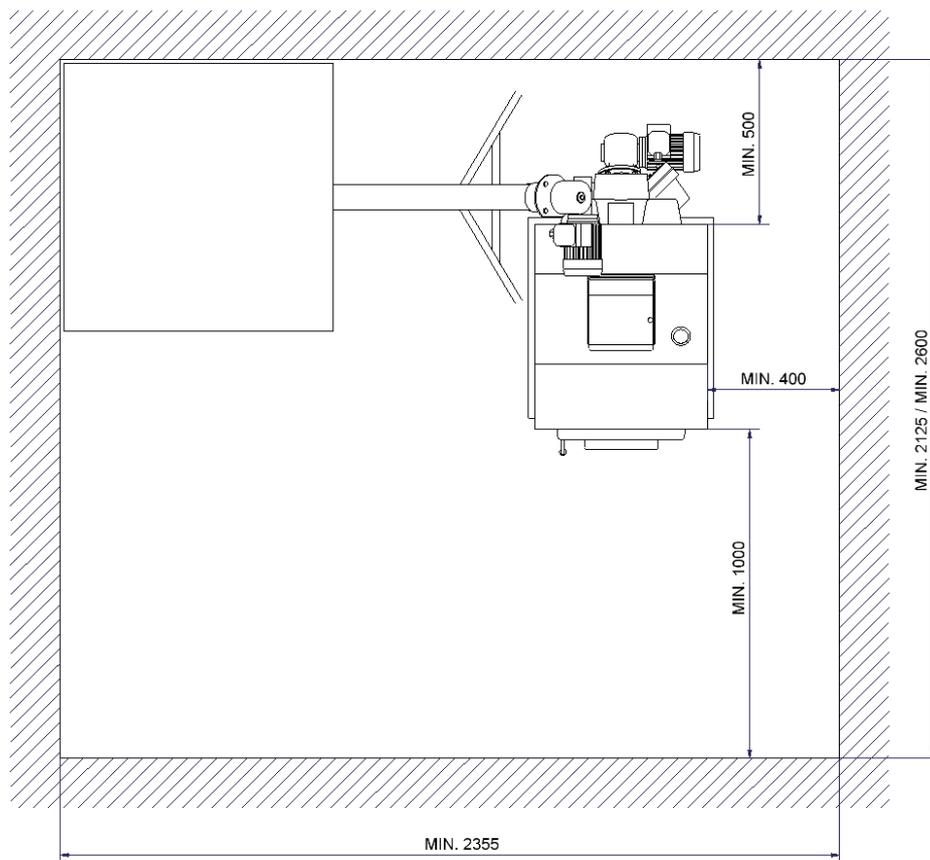
**Рис. no. 6** Расположение котла VIADRUS HERCULES ECO в котельной
