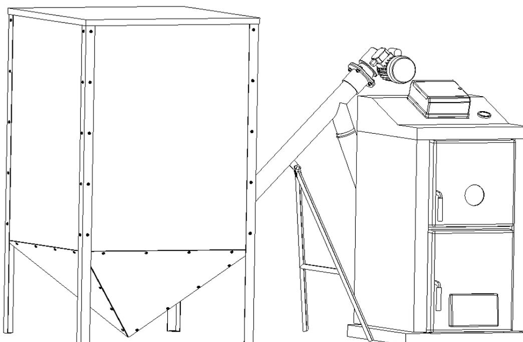
**Рис. но. 1 Вид котла спереди VIADRUS HERCULES ECO с бункером топлива – левая версия**
