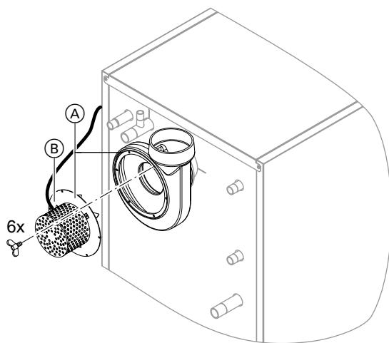
1. Ослабить барашковые винты на дымососе **(A)** и вытащить мотор **(B)** с крыльчаткой вентилятора.
