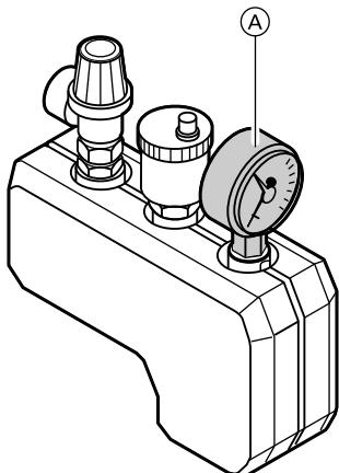
1. Проверить давление отопительной установки по манометру (A):
