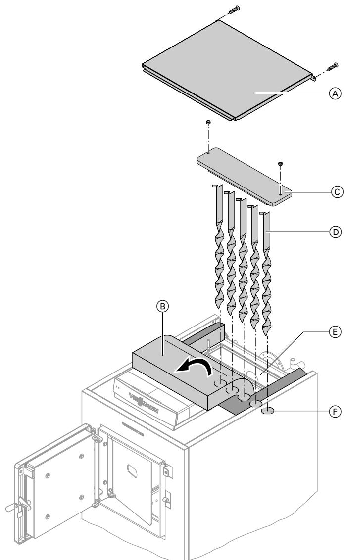
1. Снять заднюю часть верхнего щитка (A).
