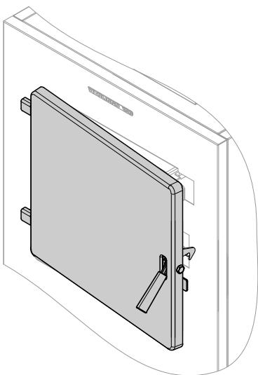
8. Закрыть заслонку полукоксового газа и загрузочную дверцу **только** до защелкивания блокировки.
