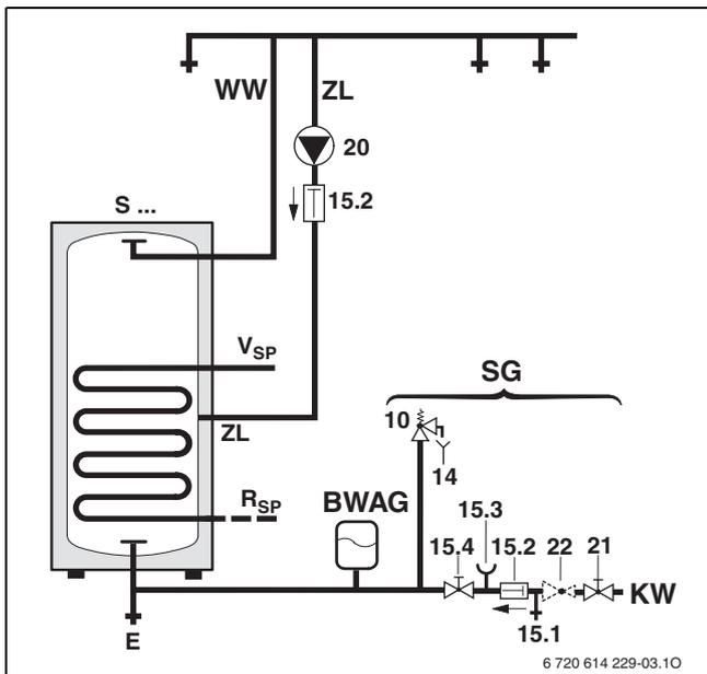
Рис. 4 Схема підключення з боку питної води
