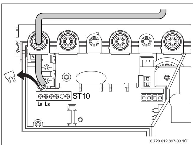
Рис 16 Подключение (230 В AC, снять перемычку между L<sub>S</sub> и L<sub>R</sub>)
