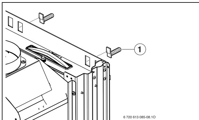
Рис 9 Подвешивание прибора
