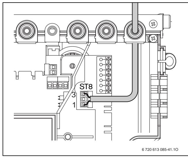
Рис 21 Подключение термостата бойлера
