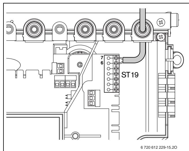
Рис 17 Подключение регулятора
