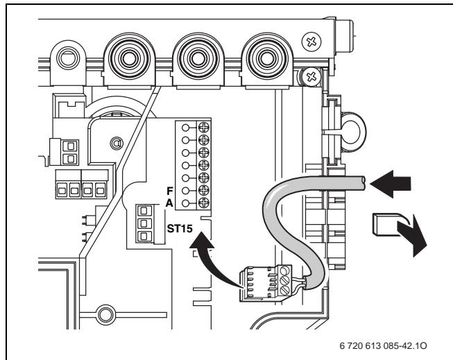
Рис 20 Разъем для подключения датчика температуры бойлера (NTC)
