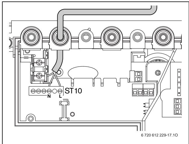
Рис 23 Клеммная колодка для подачи питания ST10
