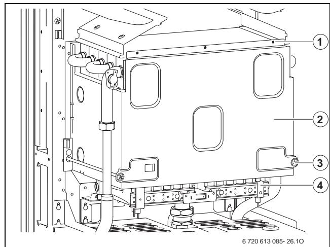
Рис 50 Открывание горелки
