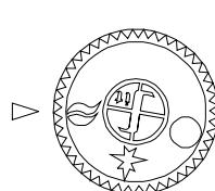
Подача газа к главной горелке разблокирована и зажигание горелки управляется автоматически ( горелка зажигается, если на закрывающийся электроклапан арматуры SIT-NOVA подается рабочее напряжение из контура внутренней проводки котла).
