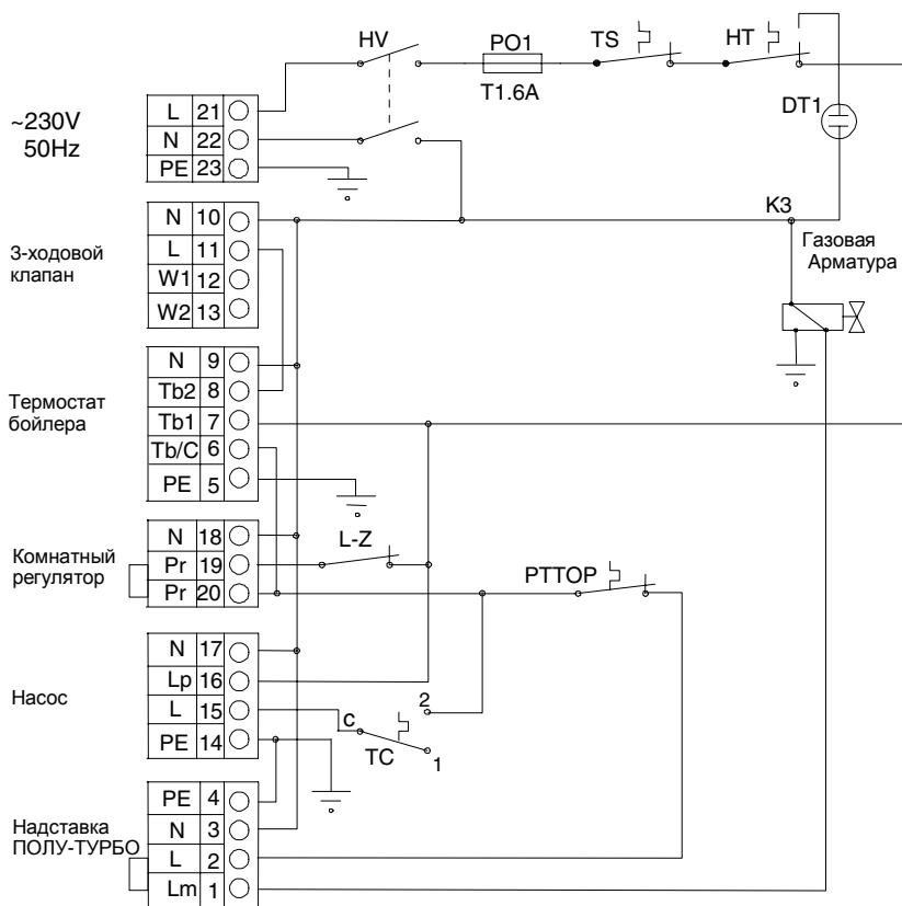
Рис. 56 – Схема электрического подключения котла 60 PLO
