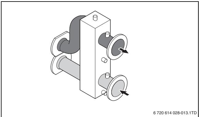
Рис 9 Гидравлический отделитель
