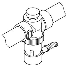
Для подключения к защитному теплообменнику водогрейного котла.
