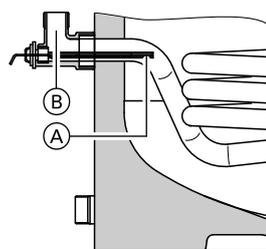
Расположение датчика температуры емкостного водонагревателя в обратной магистрали греющего контура HR<sub>s</sub>
