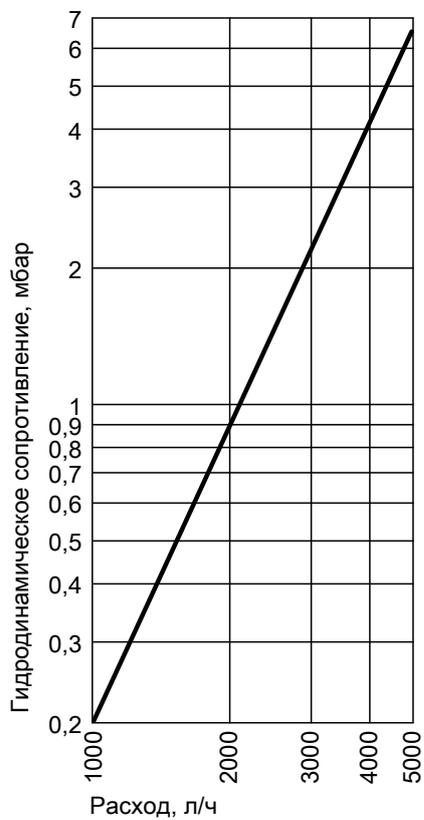
Гидродинамическое сопротивление на стороне греющего контура
