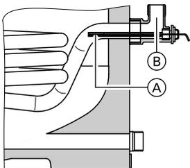
Расположение датчика температуры емкостного водонагревателя в обратной магистрали греющего контура HR<sub>s</sub>
