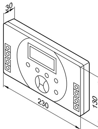
Размещение в типовом помещении на внутренней стене напротив радиаторов. Не устанавливать на полках, в нишах, а также в непосредственной близости от дверей или источников тепла (например, прямых солнечных лучей, камина, телевизора и т.п.) Датчик температуры помещения подключается к Vitotrol 300A.
