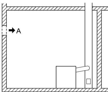
$$A = 150 \text{ см}^2 + 2 \frac{\text{см}^2}{\text{кВт}} \times (\sum \dot{Q}_n - 35 \text{ кВт})$$
