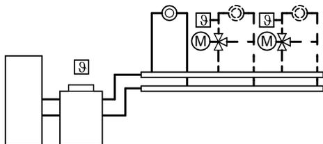
Контроллер погодозависимого цифрового программного управления котловым контуром и отопительными контурами:
