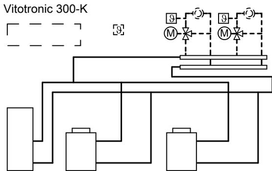
Контроллер цифрового программного управления котловым контуром:
