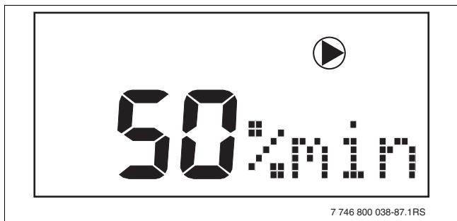
Рис 49 Показания на экране: «модуляция насоса»
