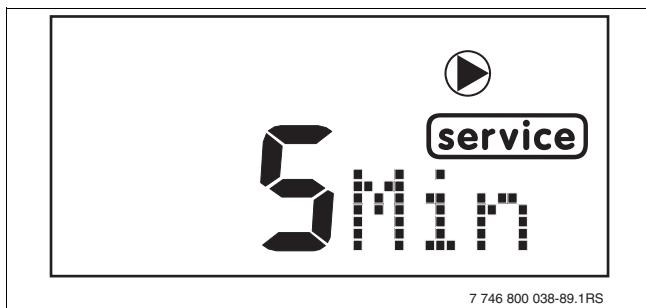
Рис 50 Показания на экране: «время выбега насоса»
