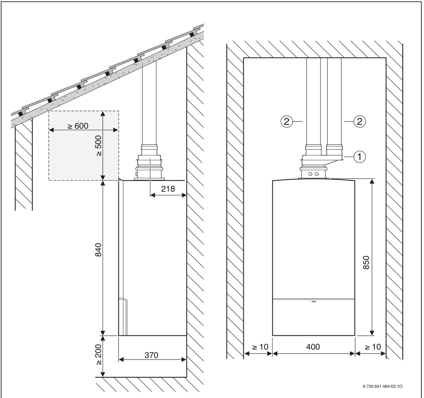
Рис 11 Раздельное подключение труб  $\varnothing$  80/80 мм, наклонная крыша
