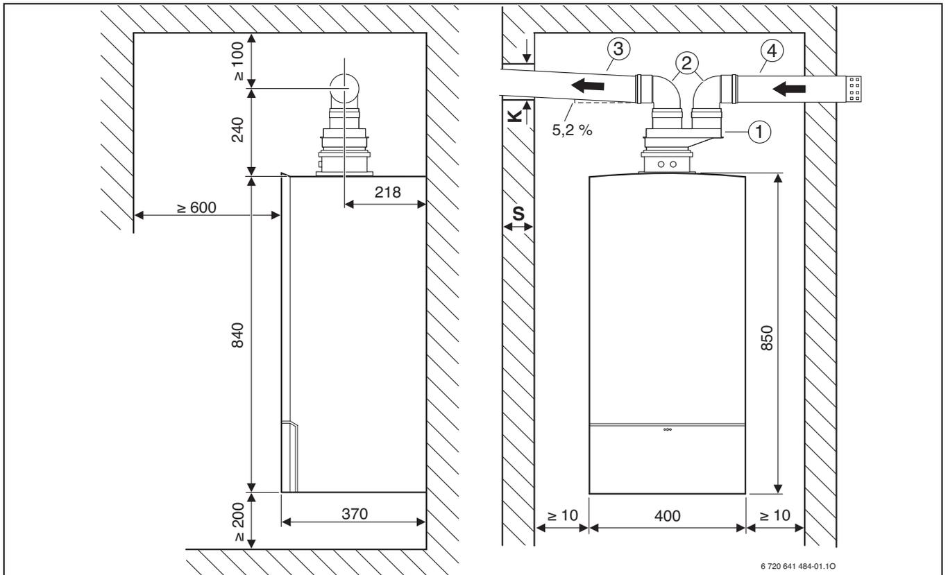
Рис 7 Раздельное подключение труб  $\varnothing$  80/80 мм
