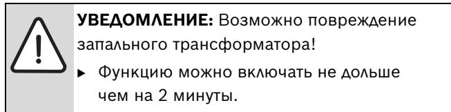
Эта функция позволяет выполнять постоянное зажигание без подачи газа для проверки розжига.
