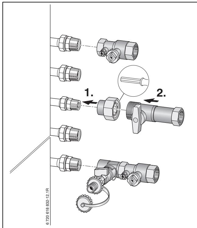
Рис 12 Монтаж сервисных кранов № 862 на примере подключений справа № 1334
